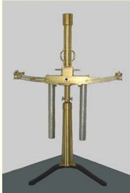
"Eötvös-inga" vagy másnéven torziós inga (torsion balance)
